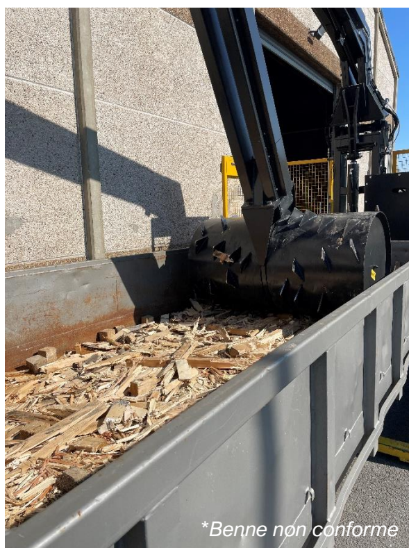
*Benne non conforme
