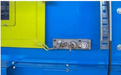
Verrouillage des serrures avec un système de clés s'assemblage
