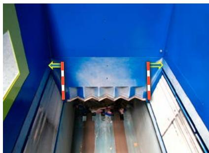
Le système de précompression à trappes latérales élargit l'ouverture de remplissage avec une élévation minimale.
