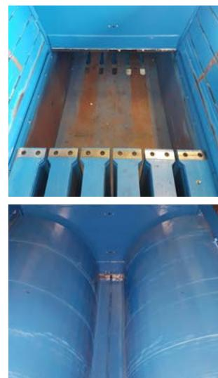
Les trappes latérales dans l'ouverture de remplissage se ferment en même temps et le résultat est un canal fermé de la presse, qui permet la production de balles compactes optimalement lourdes, homogènes et bien formées pour un chargement plus facile.
