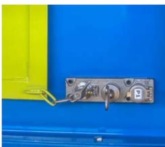
Verrouillage des serrures avec un système de clés d'assemblage
